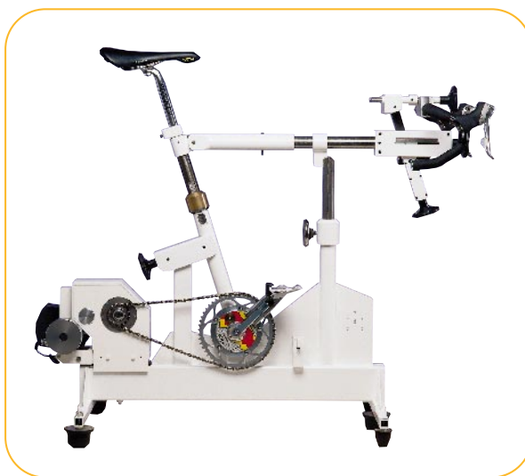
Au sommet de l'optimisation: le DynaOne, un vélo dynamométrique dont tous les éléments sont réglables au 1/10 de mm.
