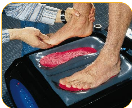
FootOne: Système de fabrication de semelles podomorphologiques sur coussins déformables.
