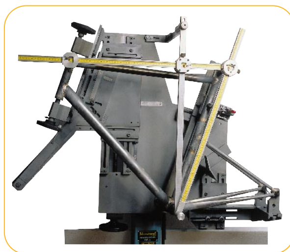
Le BrazerOne, un système permettant de vérifier la conformité du cadre aux mesures.
